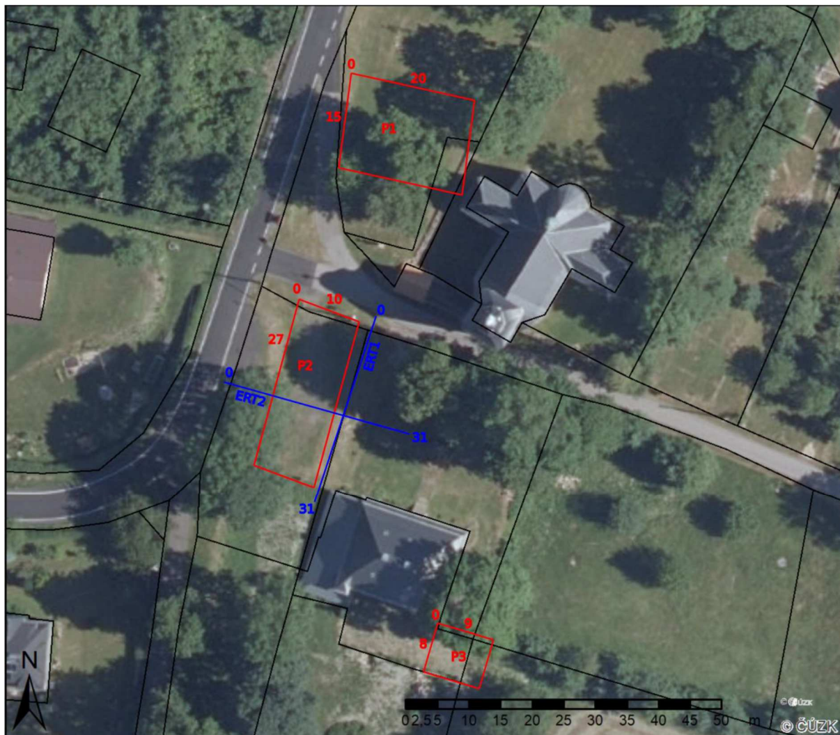
Obr. 5. Přehled a umístění oblastí měřených geofyzikou. Červené polygony byly proměřeny georadarem (GPR) a modré profily elektrickou odporovou tomografií (ERT).
